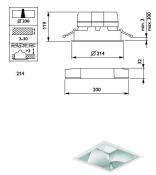
Technische Daten Philips LED Downlight LuxSpace Quadrat DN572B VLC-E 10.3W 1350lm 80D - 840 Kaltweiß | 214mm - Aluminium Reflektor - Dali Dimmbar
